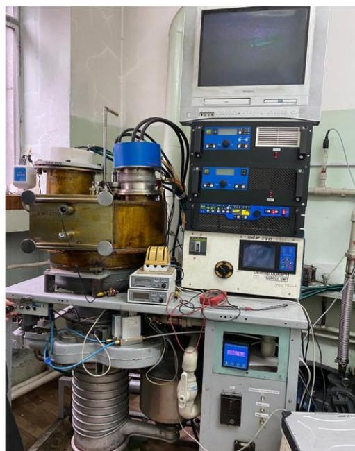
Рисунок 2.2 – Общий вид установки магнетронного распыления; магнетронами APPEL-MRE100
