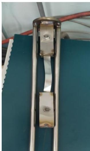
Рисунок 2.6 – Образец, закрепленный в держателе
