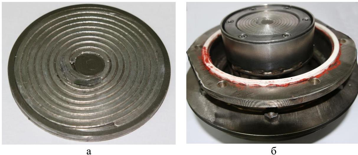
Рисунок 2.3 – Полученная из Pd проволоки  $\varnothing 3$  мм мишень (а) и ее монтаж в магнетроне APEL-MR-IN75 (б)
