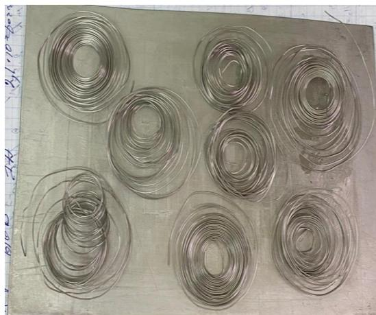
Рисунок 2.1 – Проволоки из Nb и Ta в форме «Архимедовой спирали»
