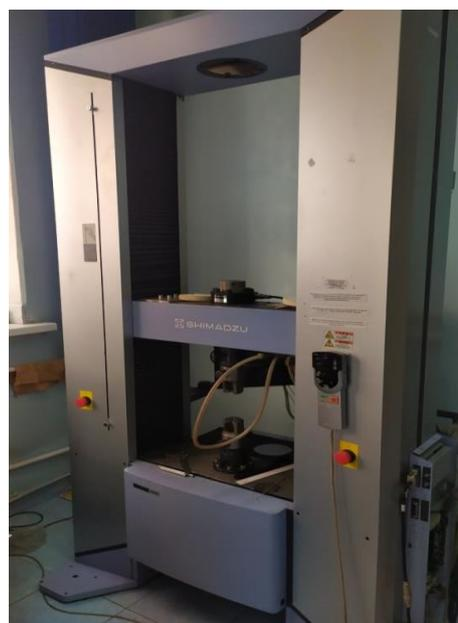
Рисунок 2.4 – Электромеханическая испытательная машина Shimadzu AG 100kN $\times$
